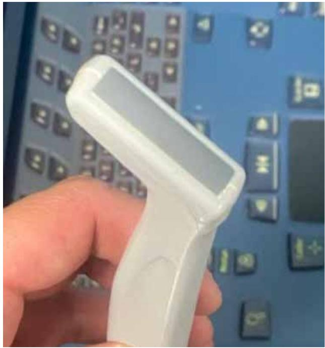
**Figura A. Transductor tipo "Hockey Stick" o en palo de Hockey.**
