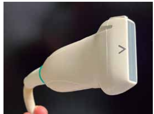
Figura 1: Transductor lineal portátil ( Lumify Phillips ). El transductor y el procesador están contenidos en el dispositivo, la imagen se genera al conectarlo a una tableta o a un teléfono inteligente.
